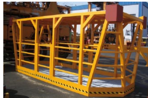
Safety cages Cestas de seguridad
