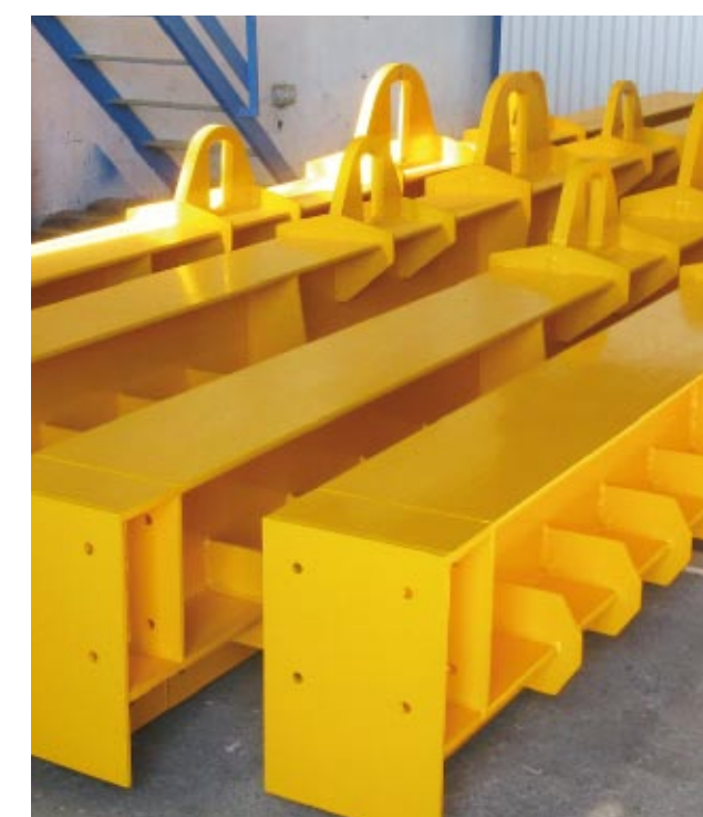
Spreader 200 tns capacity Balancín de 200 tns de capacidad
