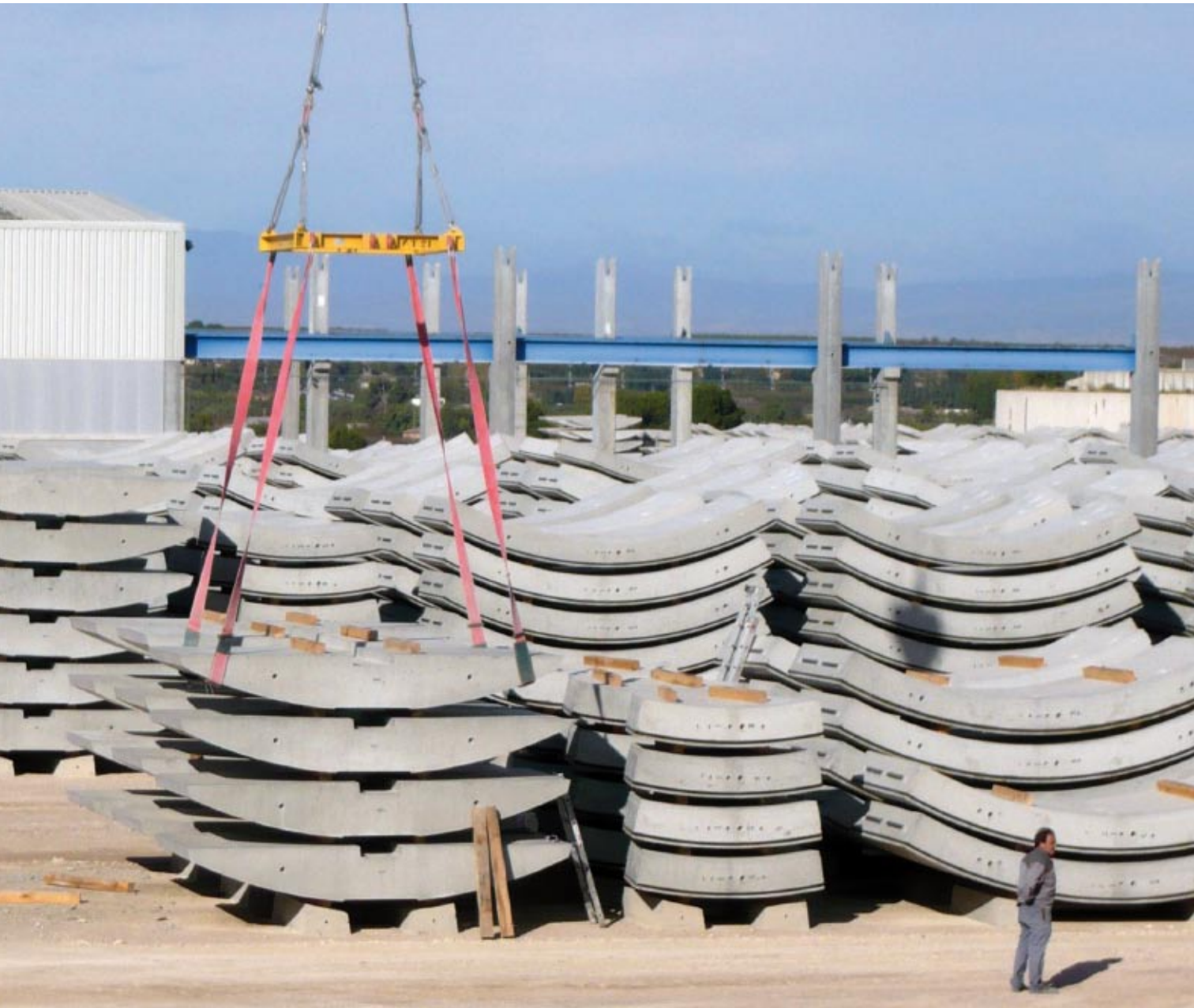
Spreader for concrete precast sector Balancín para el sector del prefabricado de hormigón
